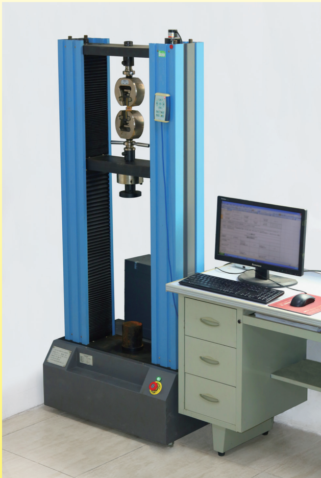
断裂抗张强度和延伸率的测试设备
